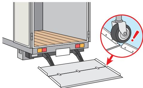
折り畳み部周辺のサイドストッパーに隙間が生じるので、隙間から車輪が脱輪しないよう、注意してください。
